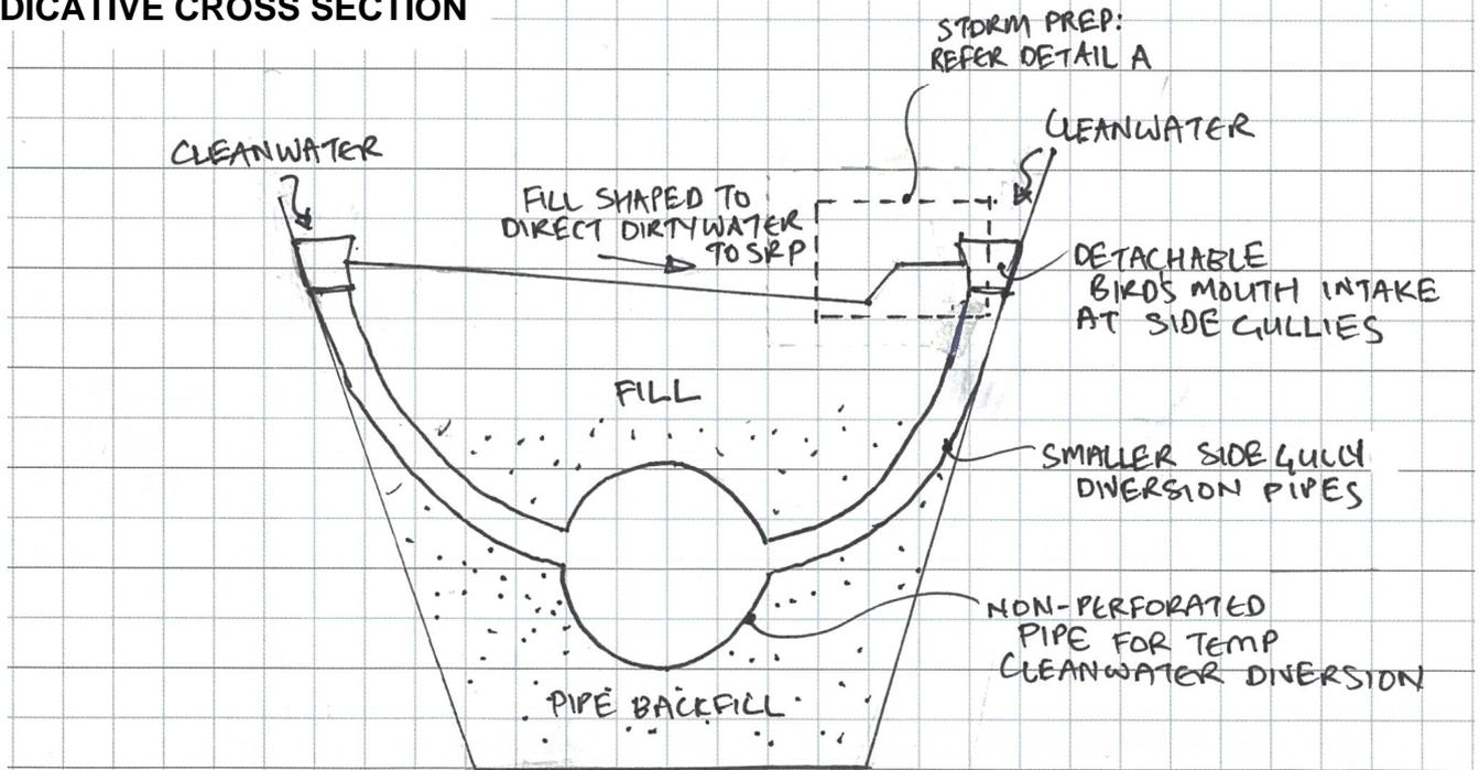
**DETAIL A: PREPARATION PRIOR TO SIGNIFICANT STORM EVENT**
