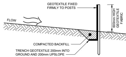
**TYPICAL SECTION - SILT FENCE**
