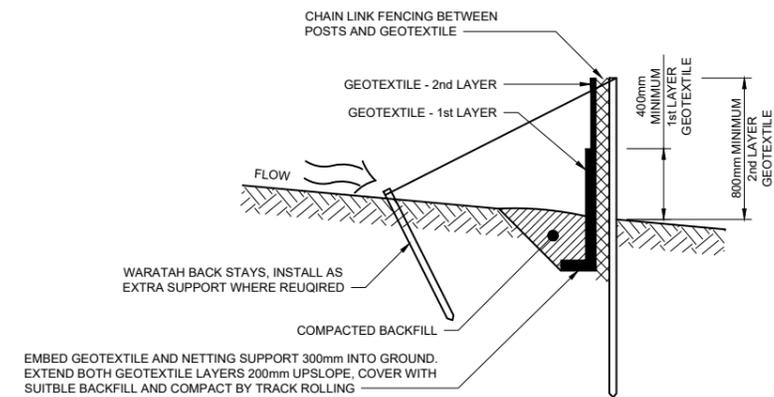
**TYPICAL SECTION - SUPER SILT FENCE**
