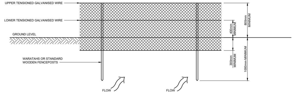
**ELEVATION - SUPER SILT FENCE**
